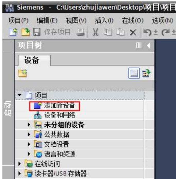
3.弹出“添加新设备”窗口，进行“控制器→SIMATIC S7-1500→CPU→CPU 1511T-1 PN→6ES7 511-1TK01-0AB0”操作,点击确定：
