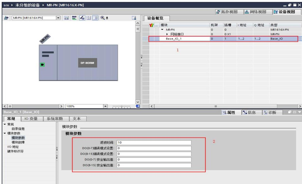
7. 在模块的未分配上左击鼠标，选择PLC\_1.PEOPFINET 接口\_1，即可将MR-PN的模块连入PROFINET网络中：
